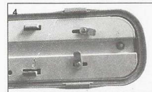
4. Fijar a presión el soporte metálico (B) a la carcasa gris de la lámpara (A).
