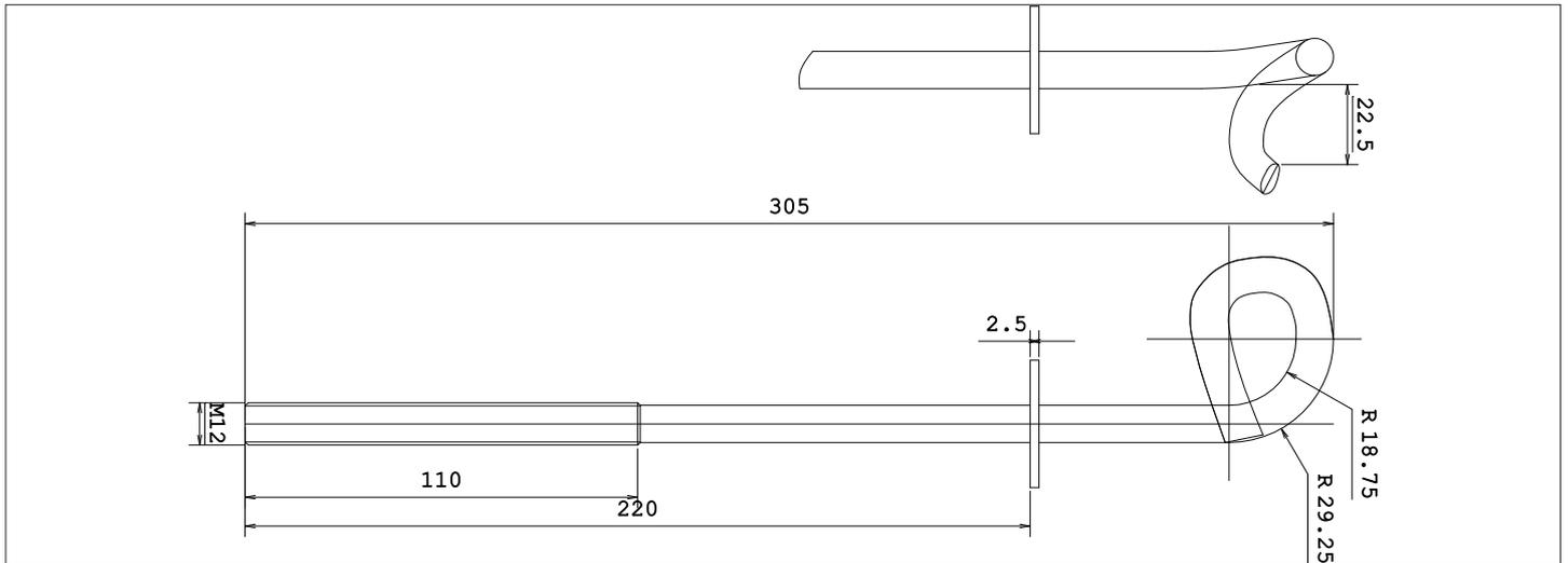
1) Material: Aço Galvanizado a Quente, Aço electrozincado, Aço Inoxidável.
